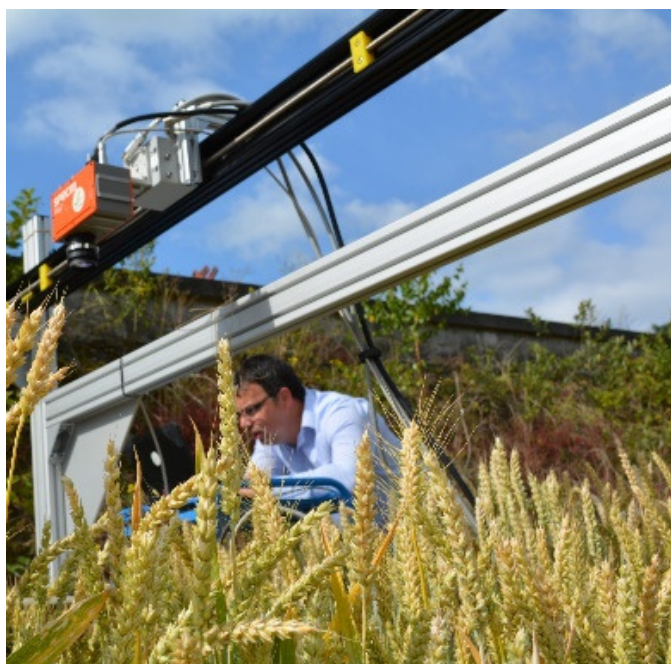
Figure 11.24 – Plateforme de mesure d'imagerie hyperspectrale de terrain.
